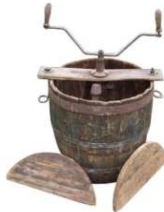
Waschmaschine mit „Hin- und Herbewegung“. Sie besteht aus einem Fass, in dem drei Rührflügel anhand einer an der Oberseite des Bottichs befestigten Handkurbel von zwei Personen hin- und herbewegt werden.
