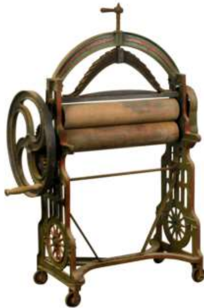
Grandeessoreuse à rouleaux sur roulettes, tout en métal. Le niveau de pression varie en fonction du serrage de la poignée présente au sommet du cadre.
